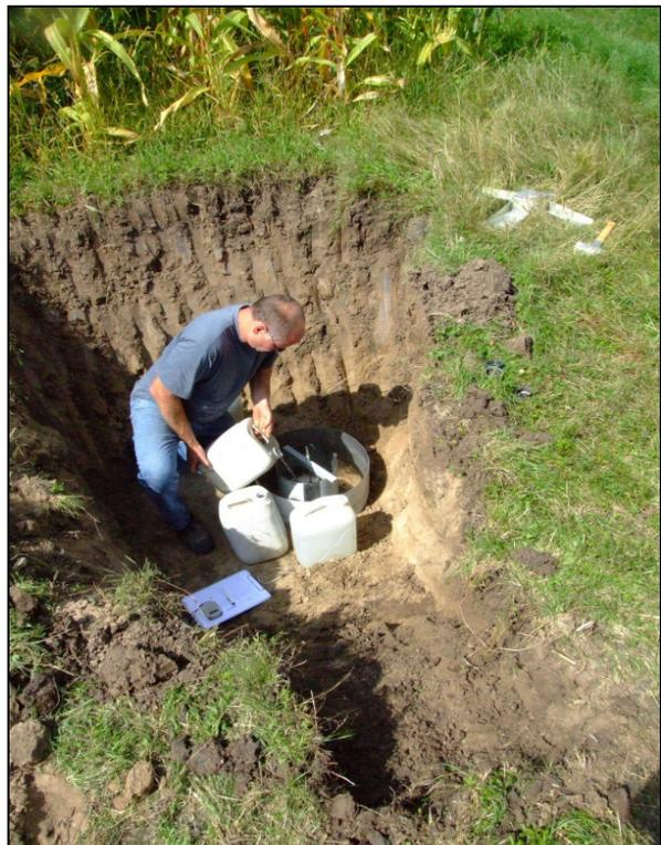
Bild 4: Versickerungsversuch in Schurf 2 mit Doppelinfiltrimeter
